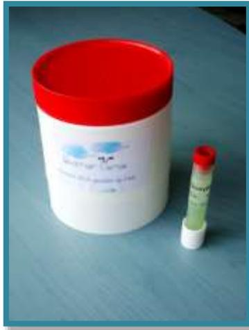
Figure 2 : Échantillonneur passif pour le dioxyde d'azote (NO<sub>2</sub>) et sa boîte de protection contre les intempéries (Source : Qualitair Corse)
