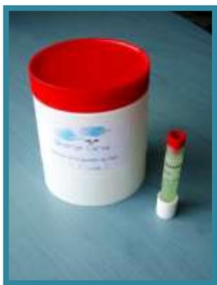
Figure 1 : Échantillonneur passif pour le dioxyde d'azote (NO<sub>2</sub>) et sa boîte de protection contre les intempéries (Source : Qualitair Corse)
