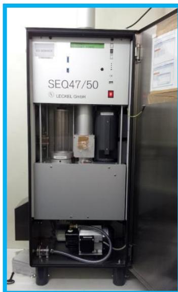
Ces appareils permettent de prélever les HAP (benzo(a)pyrène) mais aussi d'autres composés comme les pesticides, les particules fines ...
